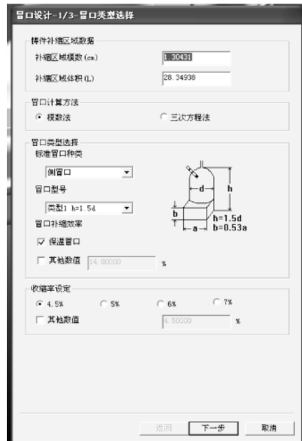
图6 载重车铸钢后桥冒口CAD运行界面
