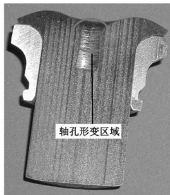
图 12 铆头倾角 1^\circ 时铆装后轴端变形图
