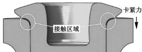
图 8 被铆轴端与轴承内圈接触区域半剖图
