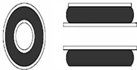
图 3 橡胶衬套结构示意图
