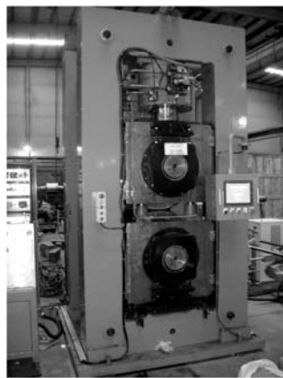
图 1 液压控制式极片轧机实物图
