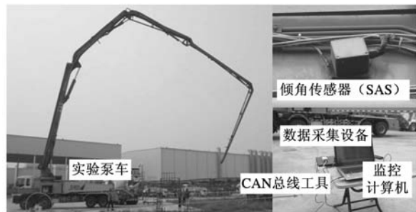
图 5 臂架振动测试系统
