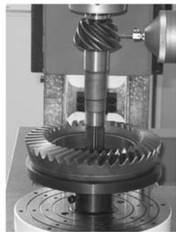
图 5 齿面误差测量
