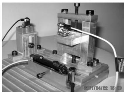
(b)对刀装置实物
