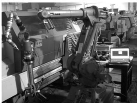
图 2 工业机器人定位误差测量系统
