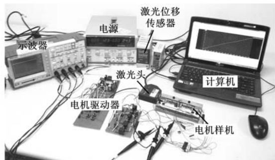
图 9 试验硬件平台
