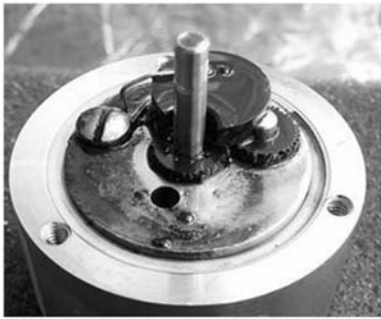
图4 磨损破坏的齿轮泵部件
