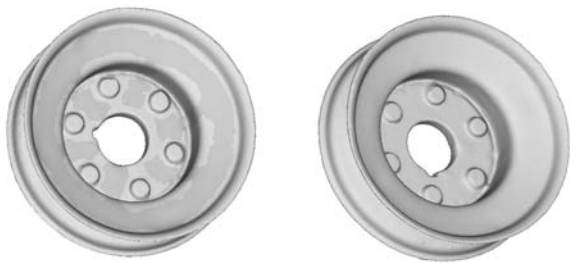
图 11 复杂 Pulley 孔洞模型边界 C^1 连续修复结果
