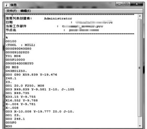
图9 UG生成的数控加工代码
