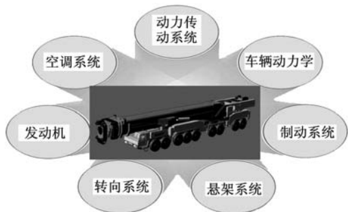
图 3 起重机整车模型系统组成
