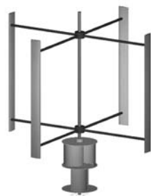
图 9 萨布纽斯型和直叶片型达里厄风力机的混合类型
