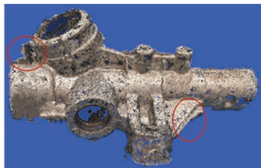
图 7 铸件的稠密点云重建结果
