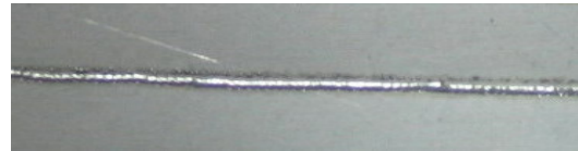
(a) 雾化 316L 不锈钢粉末的一维成形形貌 ( I_0 = 0.5 \text{ mA} , v = 1.5 \text{ mm/s} )
