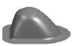
图 2 回弹预测拉深件图
