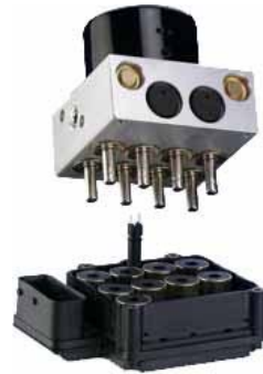
图 8 TCS 的液压执行器典型结构
