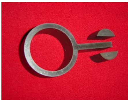
图 5 摆动转子膨胀机摆动转子与导轨实物图
