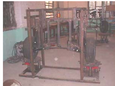
图4 带横置钢板弹簧独立悬架系统的试验台
