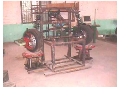
图3 麦弗逊支撑杆摆臂式独立悬架的试验台
