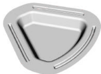
图12 加入真实拉深筋的覆盖件模型
