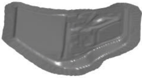
图 19 门内板冲压仿真计算结果
