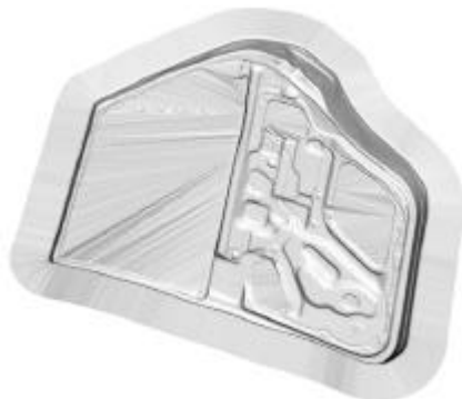
图 18 使用 STLMesher 完成工艺设计的模型
