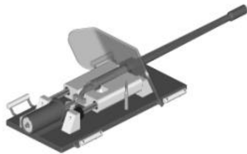
图 8 12.7 mm 机枪 MR 后坐阻尼器
