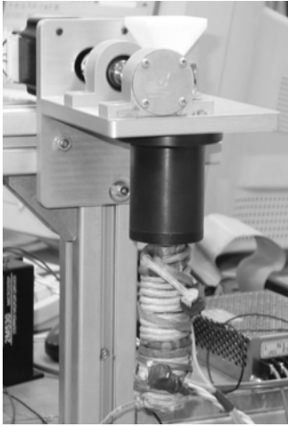
图2 颗粒体进料微型螺旋挤压堆积喷头机构实物图
