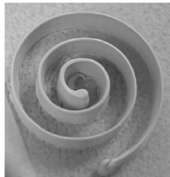
图10 堆积完毕的螺旋形路径示意图
