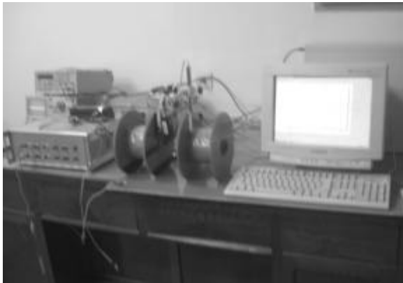
图7 磁致伸缩薄膜检测实验装置
