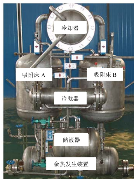
图 2 余热驱动的多功能热管型吸附制冰机组
