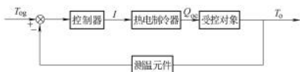
图2 应用热电机冷器的温度控制原理
