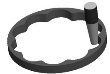
图 4 锥形圆弧内齿轮铣削模型
