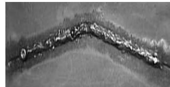
(a) 湿法焊接自动跟踪折线焊缝
