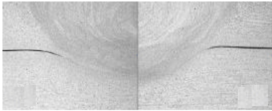
(b) 搭接试验焊缝底部材料变形
