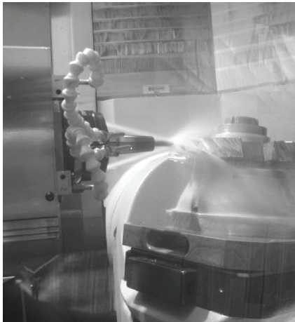
图 3 叶轮加工试验环境
