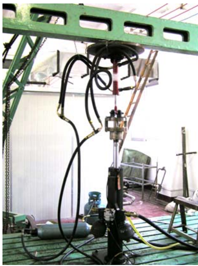
图 2 馈能装置力学特性的试验现场图
