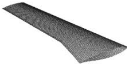
(b) 机翼蒙皮结构有限元图
