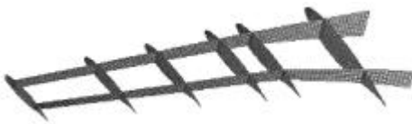
(a) 机翼内部结构有限元图
