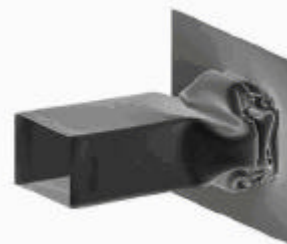
图 2 方形梁变形的有限元模拟结果
