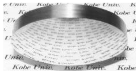
图 10 淬硬钢的超精密镜面切削硬度 61 HRC
