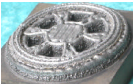
图 7 MPLS 工艺成形的金属功能近形零件
