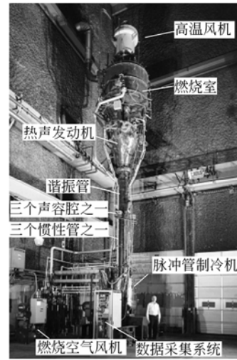
图 12 500-gpd 热声天然气液化装置
