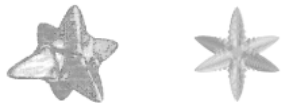
(a) 纯物质尖锐界面相场模型 (b) 二元合金弥散界面相场模型
