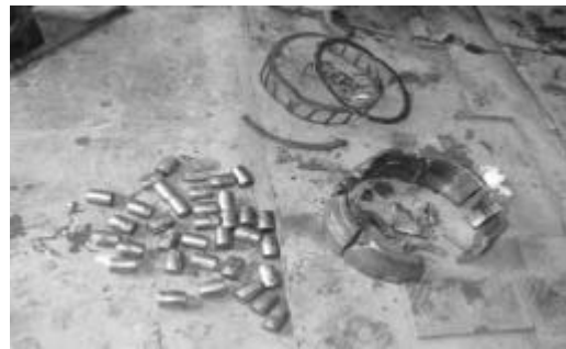
图 2 轧机齿轮箱 C10 轴承损坏实物
