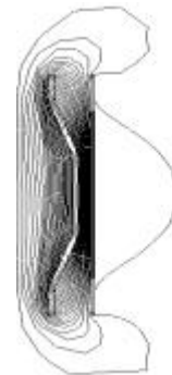
图 7 阶梯形线圈电磁胀形的磁力线分布
