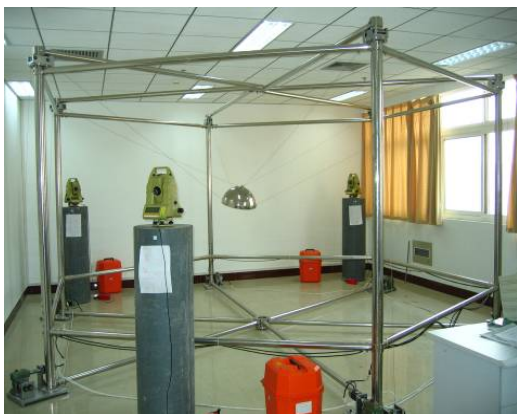
图 4 FAST 5 m 室内缩比模型
