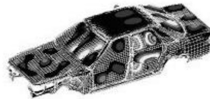
(d) f=66.111 Hz 模态的结构相对变形
