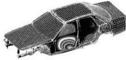
(a) f=18.643 Hz 模态的结构相对变形
