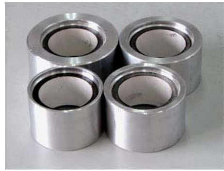
图 10 径向复合短圆管压电超声换能器样品
