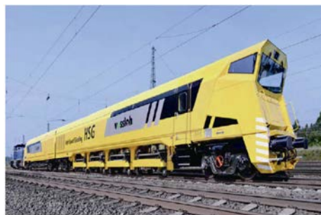
图 14 典型的砂轮高速打磨装备
