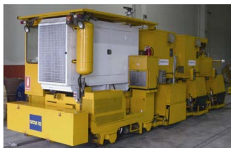
图 8 典型的砂轮周面打磨装备
