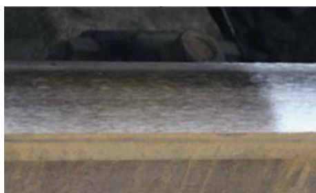
图 16 砂带打磨后的钢轨表面形态
