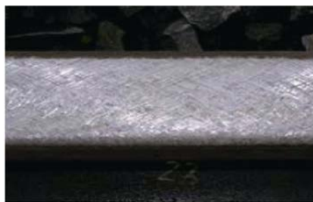
图 13 砂轮高速打磨后的钢轨表面形态
