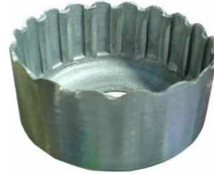
图 6 杯形薄壁矩形内齿工件的口部波浪形状
