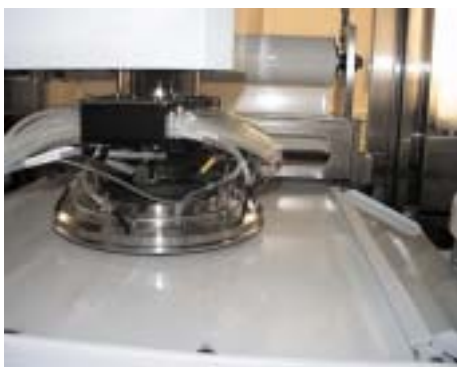
图 3 使用固结磨料抛光垫的卷带式 CMP 机床
