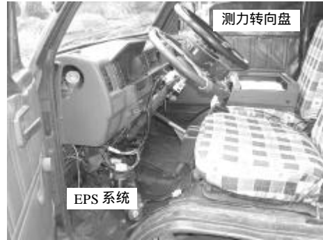
图 10 EPS 系统在车上的布置图
